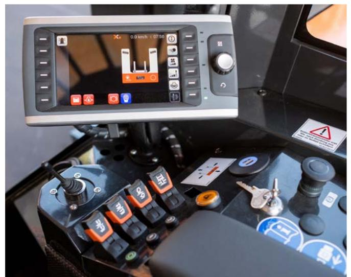
*En función de los requisitos de la aplicación, puede cambiarse entre tres modos de desplazamiento: Eco, Sensitive y Speed. Esto permite reducir las emisiones y el consumo de combustible.*
